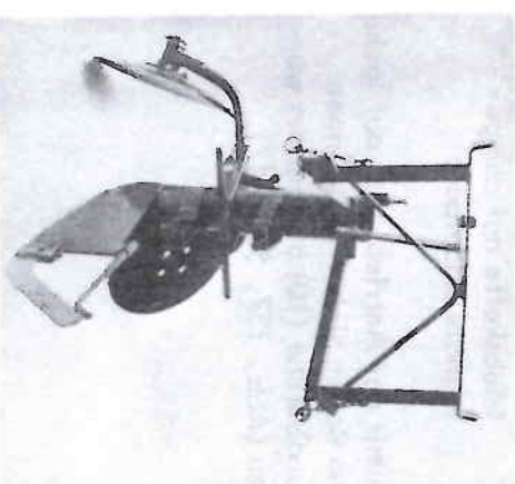
Abb. 140 Legaggregat mit Traggestell und Vorschneidsech
